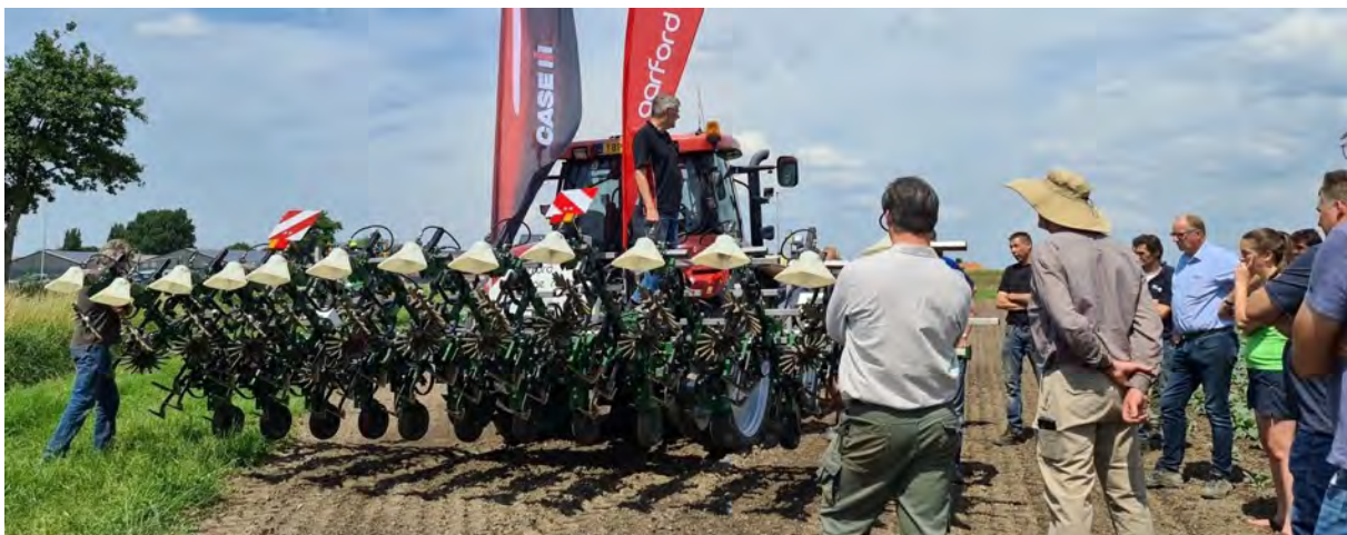
Figuur 6.11 Garfordschoffel met uniek camerasysteem werkt met vrij lange elementen, zodat voldoende ruimte is voor bijvoorbeeld schoffels, vingerwieders of spuitkappen. Dit biedt een grote variatie aan mogelijkheden.
