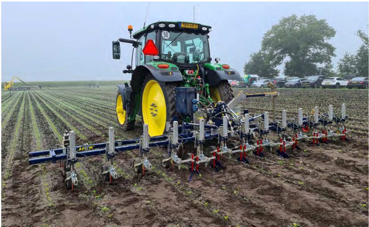
Figuur 6.10 Op deze foto is de Hak S-serie schoffelmachine te zien met Garfordcamera-systeem voor nauwkeurige zijdelinkse aansturing van de side-shift.
