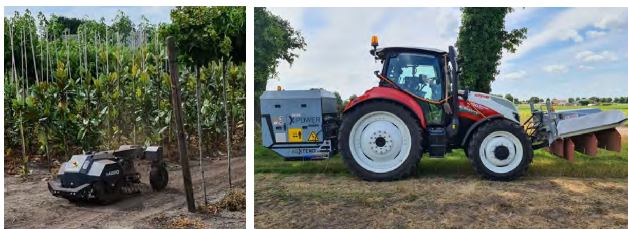
Figuur 6.12Foto links: de autonome robot Aigro up met wiedeeg.
