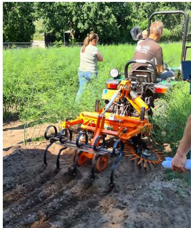
Figuur 5.3 Rineiri schoffelmachine met vingerwieders in de aspergeteelt
