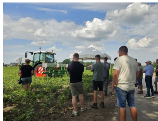
Aanwezigen bekijken een demonstratie van de Basrijs kunstmeststrooier, die met GPS gericht meststoffen kan verspreiden
